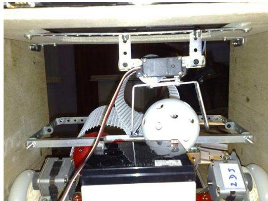
Le distributeur possède deux fonctions principales: la **détection de couleur de la balle** positionnée et l'orientation de la balle vers le bon chemin.
